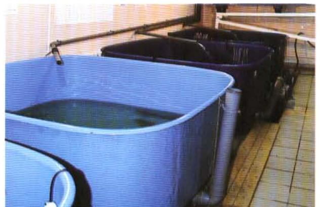
Рис. 35. Сливное колено для водосброса
