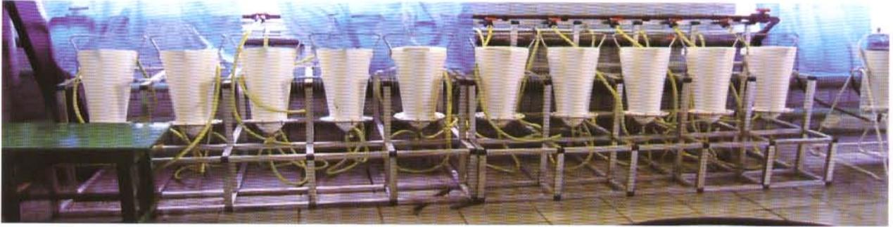
Рис. 143. Стандартные аппараты для обесклеивания икры
