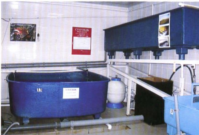
Рис. 30. Основные компоненты установки замкнутого водообеспечения
