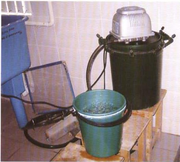
Рис. 144. Модифицированный аппарат для обесклеивания небольших объемов икры
