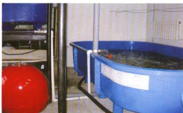
Рис. 48. Механический фильтр и бассейн для производителей
