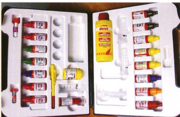
Рис. 51. Мини-лаборатория для экспресс-определения гидрохимических показателей
